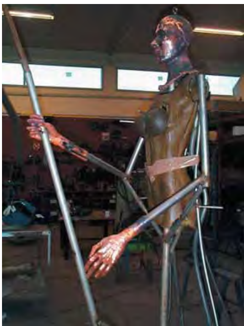
*Budbringeren* (under udarbejdelse). Der er god brug for smedefaget i forbindelse med stålkonstruktionerne der skal sikre at skulpturerne kan flyttes rundt i det offentlige rum uden at lide skade.
