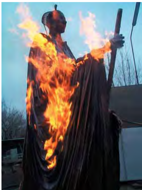
'Budbringeren'. Som led i fremstillingsprocessen af skulpturerne brændes vokskernen ud fra kobberstøbningen.
